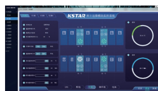
组态监控-空调
